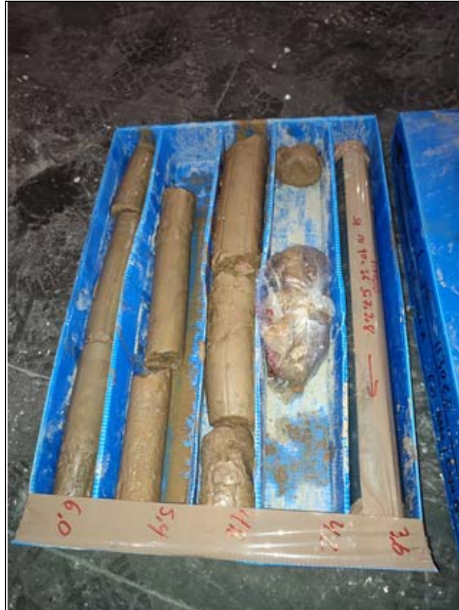
Geotècnic 1. Mostra -3/-6 m
