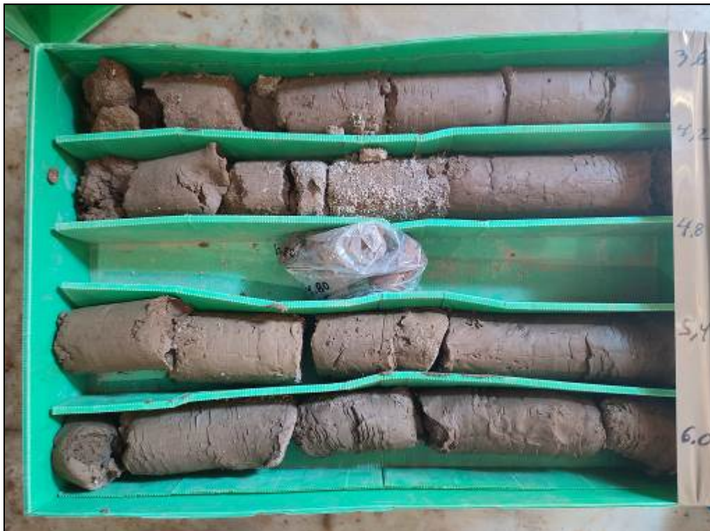
Geotècnic 3. Mostra -3/-6 m
