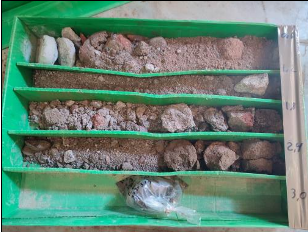
Geotècnic 3. Mostra 0/-3 m
