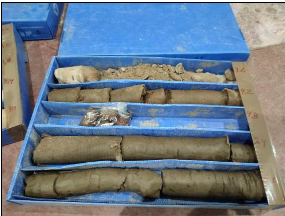
Geotècnic 2. Mostra -3/-6 m
