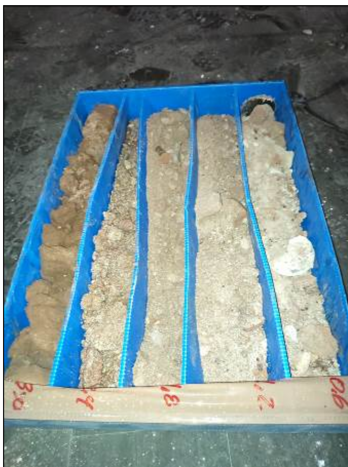
Geotècnic 1. Mostra 0/-3 m
